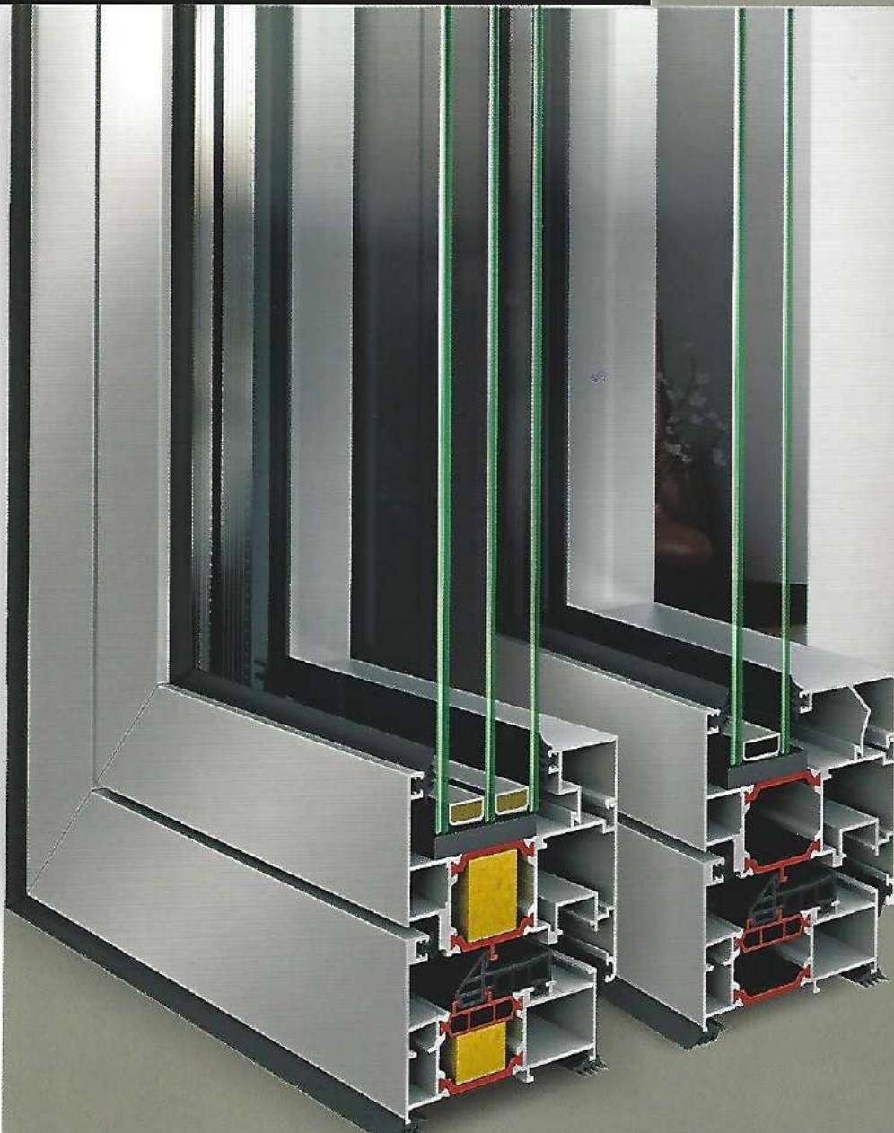
Ο σχεδιασμός του συστήματος FP 109C βασίστηκε απόνυ πο αύγχρονη τεχνολογία των κουφωμάτων. Έχει να επιδειξει μηχανές επιδόσεως σε θερμική μάνωση χάρη στα προφίλ πολυαμιδίου πλάτους 24mm. Η αριστη αυμπεριφορά της στις δοκιμές αεροπερατότητας, σε συνδυασμό με τη δυνατότητα χρήσης υαλοπινάκων πάνω από τα 44mm, δίνουν στο αυτόματα δυνατότητες επιτεύχσης υψηλής πλομώνωσης. Η δυνατότητα υπόδοχης περιμετρικού μπονιάμου κλειδώματος παρέχει απόλυτη ασφάλεια και υψηλές επιδόσεις.
